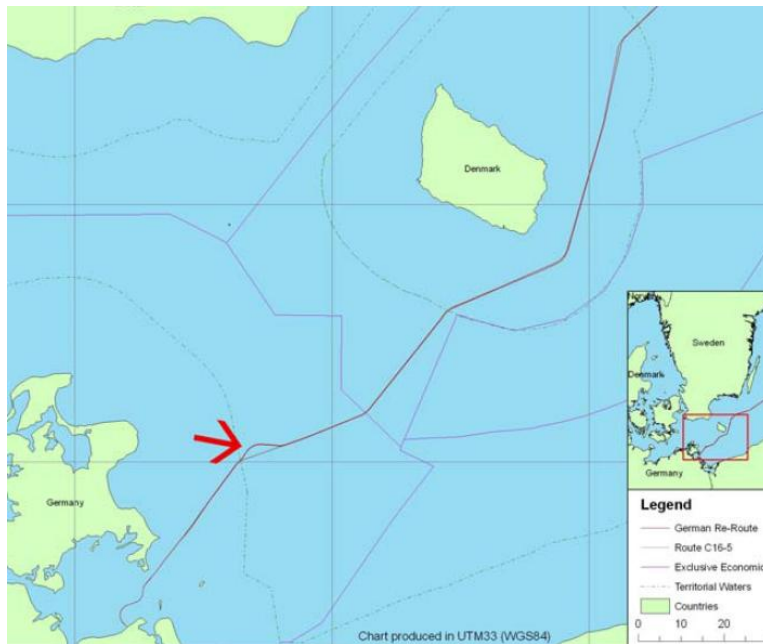
Rys.9. Przesunięcie wyoblenia trasy rurociągu
